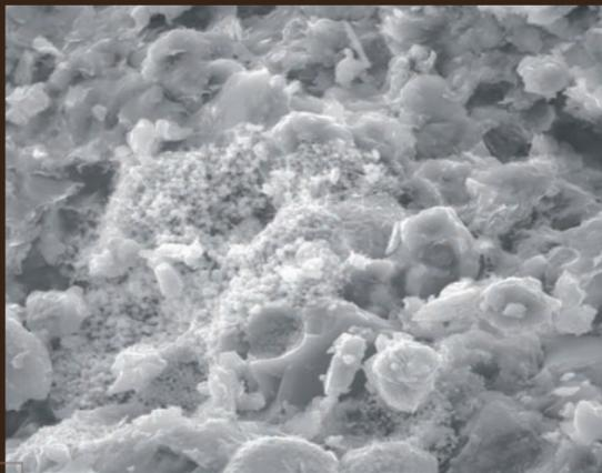
MEB d'un calcaire poreux
