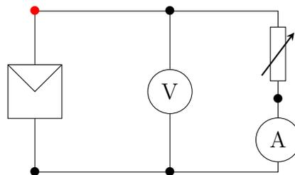
FIGURE 1.4 – Schéma du circuit de mesure de la tension et du courant pour une charge variable
