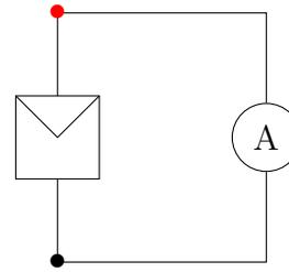
FIGURE 1.3 – Schéma du circuit de mesure du courant de court-circuit  $I_{CC}$
