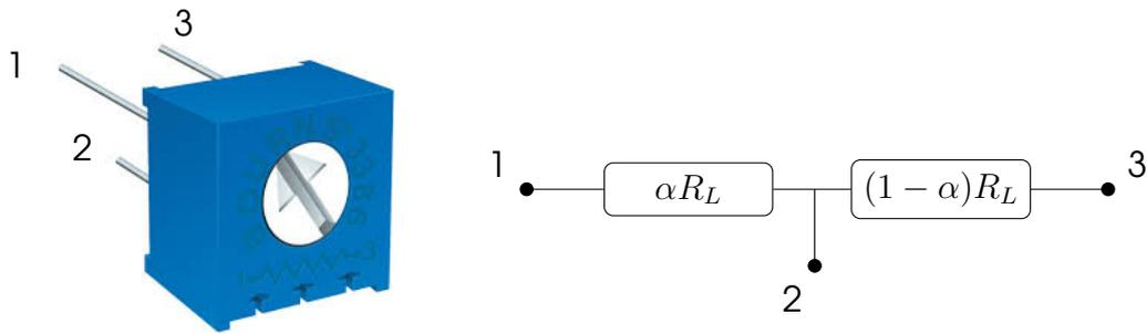
FIGURE 1.5 – Potentiomètre, tourner la vis permet de régler le coefficient  $\alpha$  entre 0 et 100%
