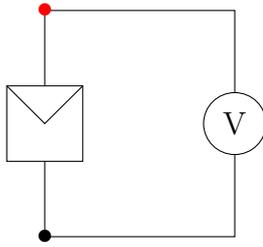
FIGURE 1.2 – Schéma du circuit de mesure de la tension de circuit ouvert  $V_{CO}$
