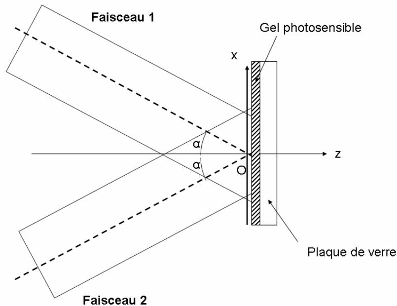
La première étape consiste à éclairer pendant un temps T, la plaque à l'aide de deux faisceaux lasers suffisamment larges et collimatés pour être considérés comme des ondes planes de longueur d'onde  $\lambda$ . Ces deux faisceaux sont incidents sur la plaque avec un angle  $2\alpha$  entre eux (la direction des ondes est contenue dans le plan  $(xOz)$ ) (voir figure ci-dessus).
