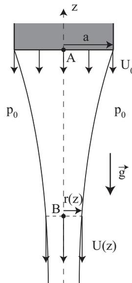
1. On souhaite déterminer les lois d'évolution d'un jet d'eau à l'air libre sous l'action de la pesanteur.
