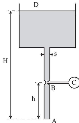
1. Calculer les vitesses  $v_A$  et  $v_B$  de l'eau aux points  $A$  et  $B$ . On donne  $H = 50 \text{ cm}$ ,  $h = 10 \text{ cm}$ ,  $s = 1 \text{ cm}^2$  et  $g = 10 \text{ m/s}^2$ .
