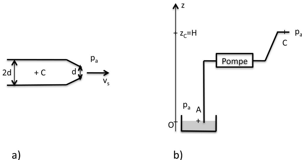
1. On commence par définir le tube délivrant le jet d'eau (fig. a). Pour des questions de confort, on souhaite maintenir l'énergie cinétique du jet à  $0.1$  Joule pour un volume d'eau de  $30$  cm<sup>3</sup>.
