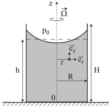
1. On repère une particule fluide par ses coordonnées cylindriques  $(r, \theta, z)$ . Quelle est sa trajectoire dans le référentiel du laboratoire ?
