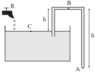
2. Dédurre du résultat une condition nécessaire au fonctionnement du siphon. Calculer  $v_A$  pour  $h' - h = 1$  m. On prendra  $g = 10 \text{ m/s}^2$ .
