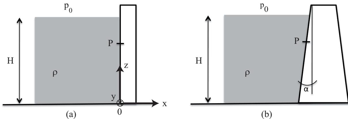
1. (a) Rappeler la loi de l'hydrostatique dans un fluide à l'équilibre de densité  $\rho$  soumis à la pesanteur  $\vec{g} = -g\vec{e}_z$ . Ecrire cette loi sous la forme d'une équation différentielle permettant de calculer la pression  $p$  dans le fluide.
