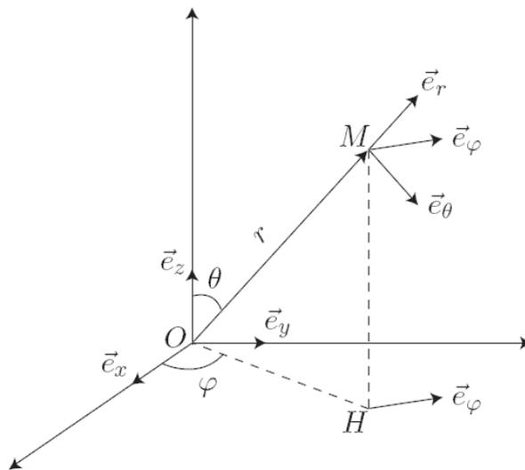
Déplacement élémentaire :  $d\vec{l} = dr \vec{e}_r + r d\theta \vec{e}_\theta + r \sin \theta d\varphi \vec{e}_\varphi$
