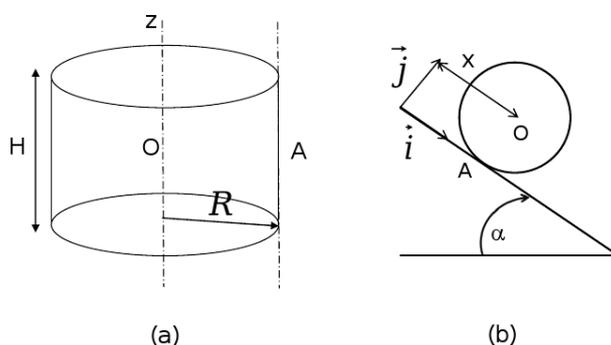
Figure 1: (a) Moment d'inertie d'un cylindre plein de rayon  $R$  et de hauteur  $H$  (homogène). (b) Cylindre roulant sans glisser sur un plan incliné d'angle  $\alpha$ .
