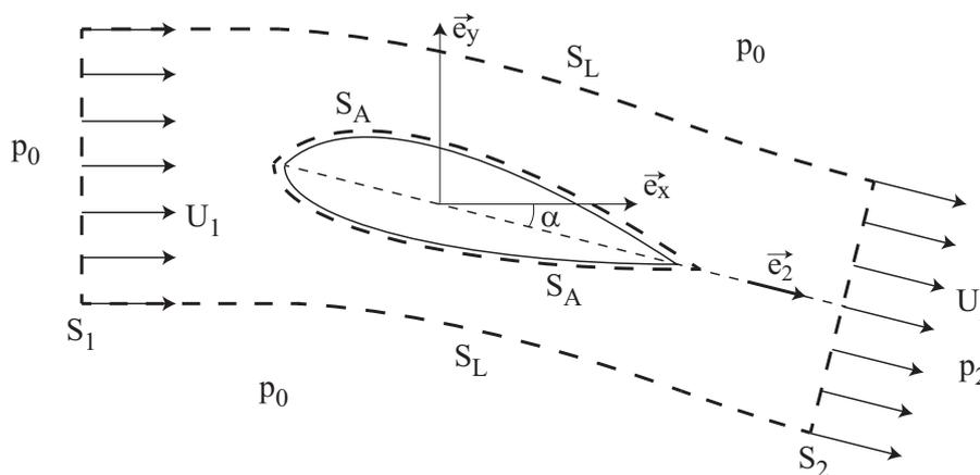
FIGURE 1 – Modèle simplifié schématisant la déflexion des lignes de courant au voisinage d'une aile.
