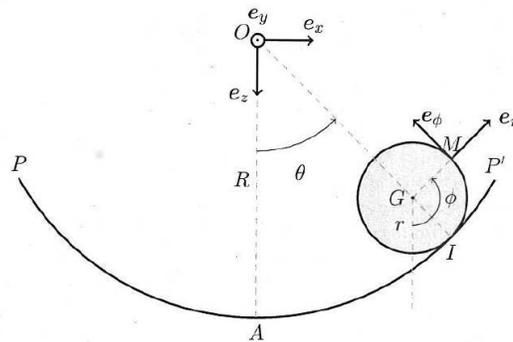
Figure 3: Cylindre de rayon  $r$  roulant dans une glissière semi-cylindrique de rayon  $R$ .
