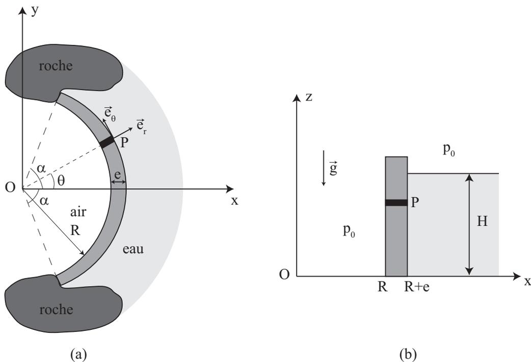
FIGURE 3 – Barrage cylindrique : (a) vue de dessus et (b) coupe verticale en  $y = 0$ .
