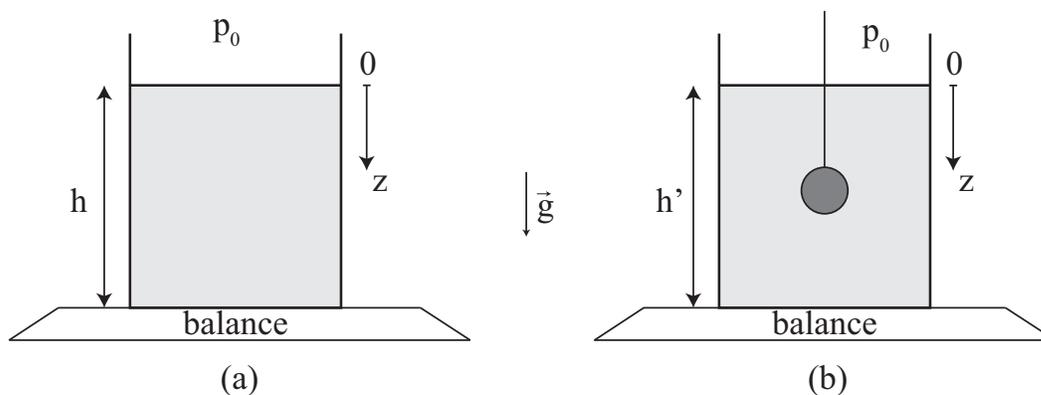
FIGURE 1 – (a) Récipient rempli d'eau sur une hauteur  $h$ . (b) On immerge la pierre précieuse dans l'eau en la suspendant par un fil. Le niveau de la surface libre est en  $h'$
