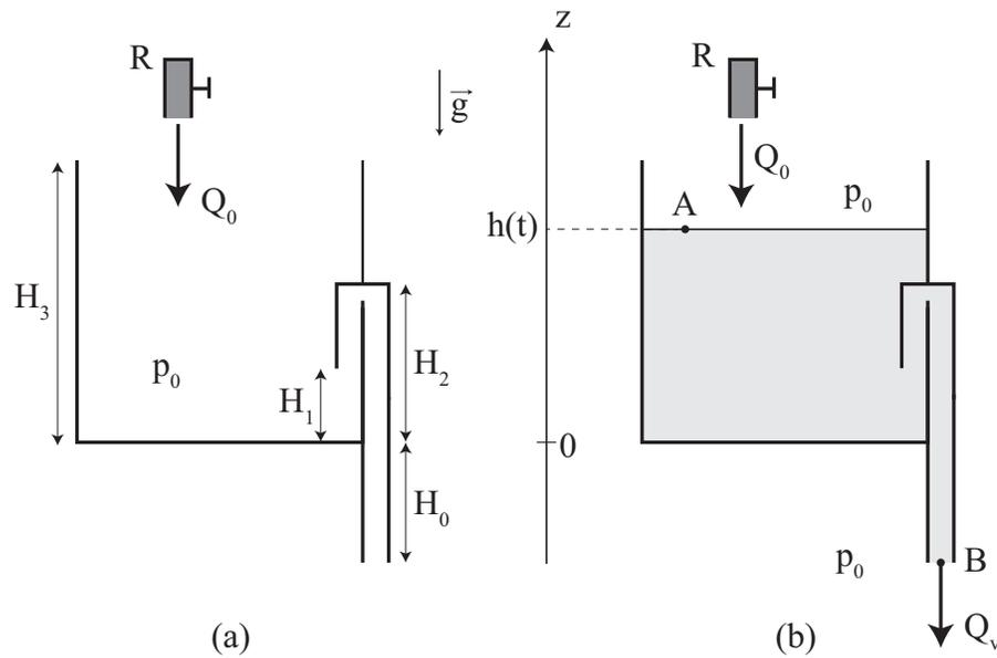
FIGURE 2 – Vase de tantale : (a) phase de remplissage avec un débit d’alimentation  $Q_0$  et (b) le siphon est amorcé de sorte que l’eau s’écoule au point  $B$  à un débit de vidange  $Q_v$ .
