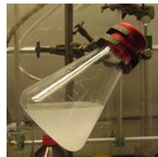
apparition de l'opalescence (partie blanche) ici dans un mélange methanol-hexane à 42.4°C
